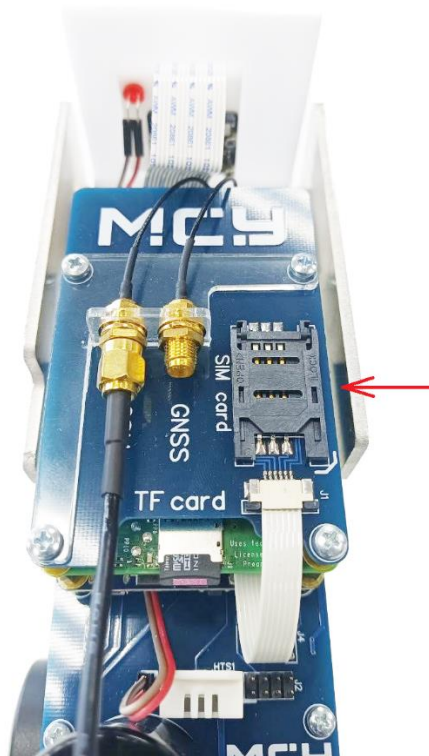
Рис. 7 – Разъем для SIM-карты ДТ «ОПТИК-Т-1»/ «ОПТИК-С-1»
