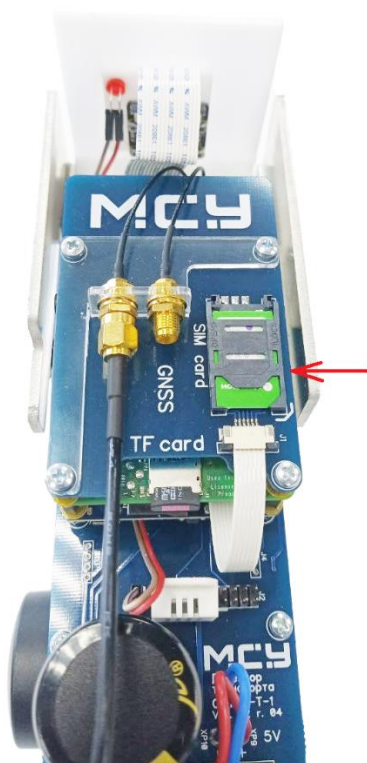
Рис.9 – Закрытый разъем с SIM-картой ДТ «ОПТИК-Т-1»/ «ОПТИК-С-1»
